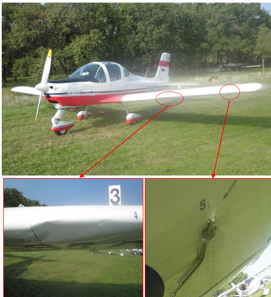
Slika 3. Oštećenja zrakoplova S5-PCO
